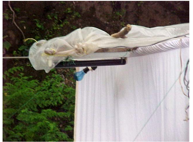
Trampa de luz, con bujías de luz mixta y de luz ultravioleta (X-2000)
