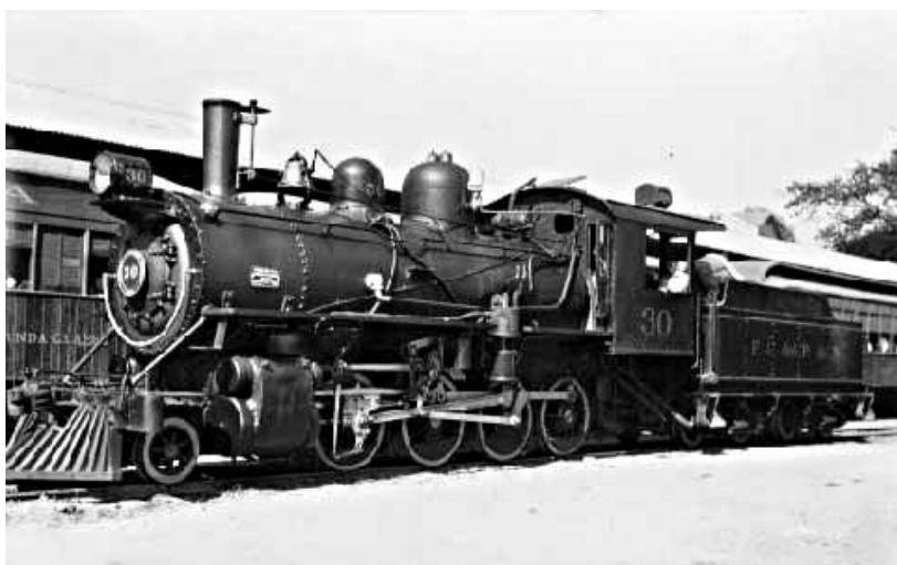
Locomotora 30. El cuerpo cilíndrico de la máquina es la caldera de vapor; la "caja" que se mira delante de las cuatro ruedas es una máquina de vapor docle que mueven las ruedas de la locomotora. Ver ilustración del funcionamiento en https://es.wikipedia.org/wiki/M%C3%A1quina_de_vapor
