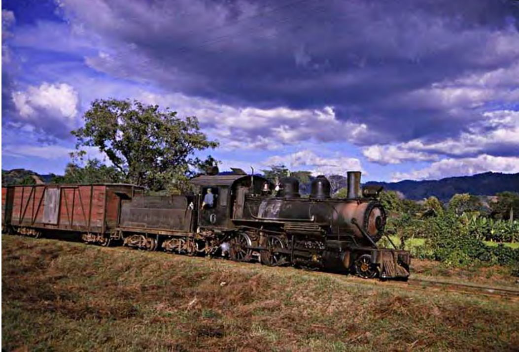
Locomotora No. 6 arrastrando un tren de carga en 1987. Nótese el color anaranjado de la caldera que muestra el recalentamiento y la corrosión. Fuente: Mi Matagalpa, Ferrocarril 1987 by Lester.
