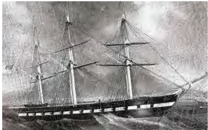
USS Levant, una corbeta idéntica al Cyane. Era de 792 toneladas, medía 132' 3" de largo, y 34' 3" de manga. Estaba armada con 18 carronadas, cañones de 32 libras, y 4 cañones de tiro largo de 24 libras. Fuente: USS Cyane Project .
