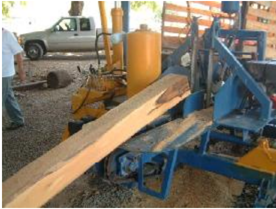
Foto 5.2. Equipo de aserío de fabricación nacional, con hoja y cadena de motosierra (Precious Woods)
